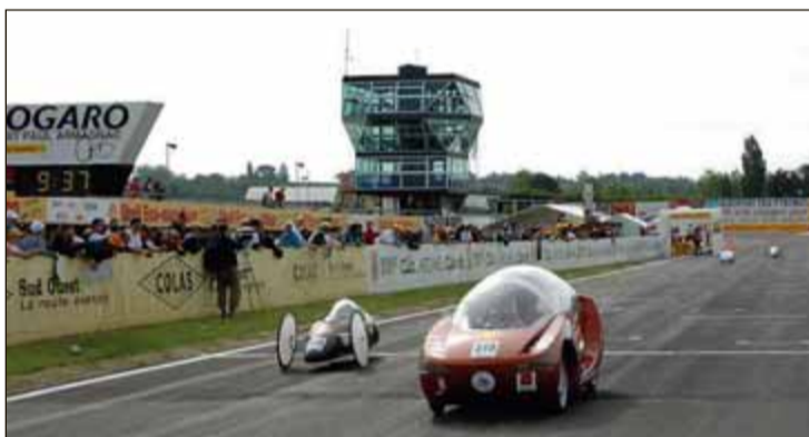
NORTH-1: Med biodiesel på tanken kjørte i 2006 North-1 9 mil på den strengt tilmålte literen med drivstoff.
